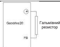
Рис. 12-3. Схема підключення гальмівного резистора
