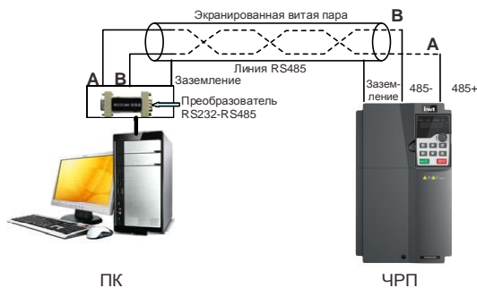
Рис. 9-1 Схема подключения RS485 для сети с одним ЧПП
