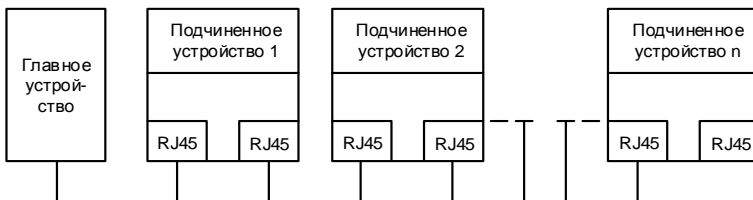
Фигура А-1 Схема электрических соединений топологии линейной сети
