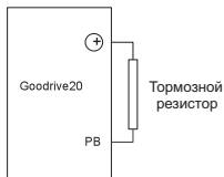
Рис. 12-3. Схема подключения тормозного резистора
