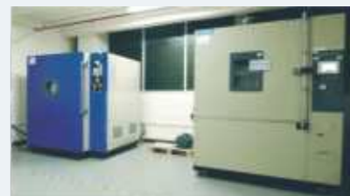
Камера испытаний на воздействие низкого давления (слева)
