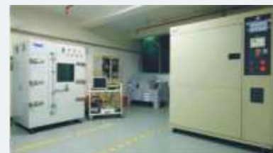
Камера испытаний на естественную конвекцию (слева)
