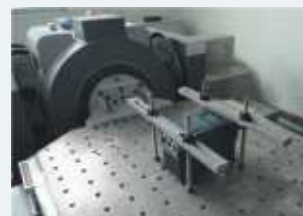
Система вибрационных испытаний электромагнитным возбудителем
